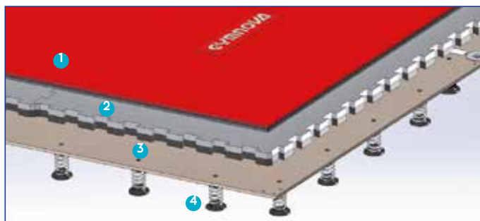
1/可卷曲跑道 - 2/拼插泡沫板 3/弹力底板 - 4/弹簧。
