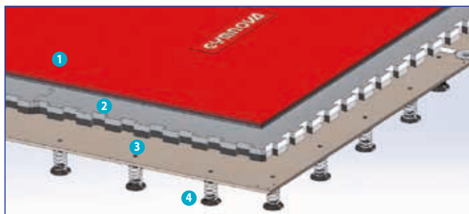
1/ Рулонные дорожки - 2/ Пластины из пенки в форме «пазл» - 3/ Пружинные ковры - 4/ Пружины.
